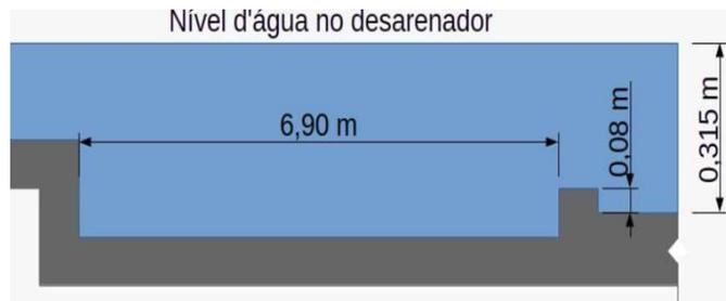
Nesta condição, pode-se inferir que a taxa de aplicação hidráulica e a velocidade horizontal no desarenador são, respectivamente:
